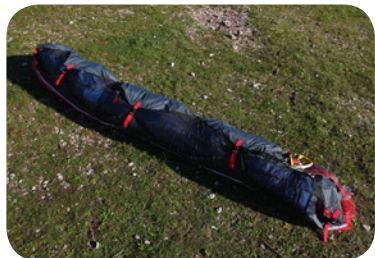
図8. ウィンナーバッグを横向きにし、フォールディング枕を適切な位置に取付け、三つ折りでリーディングエッジとトレーリングエッジをたたみ込みます。
