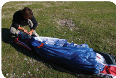
図8. ウィンナーバッグを横向きにし、フォールディング枕を適切な位置に取付け、三つ折りでリーディングエッジとトレーリングエッジをたたみ込みます。
