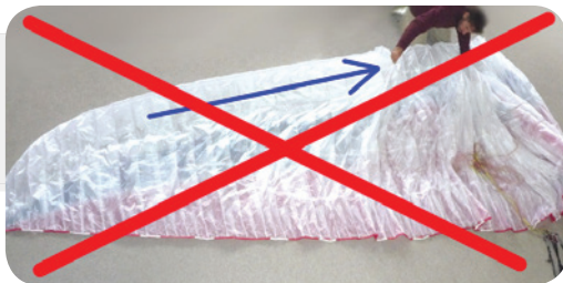
図8. ウィンナーバッグを横向きにし、フォールディング枕を適切な位置に取付け、三つ折りでリーディングエッジとトレーリングエッジをたたみ込みます。
