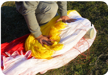
図6. 折りたたんだグライダーを、インナーバッグに収めます。
