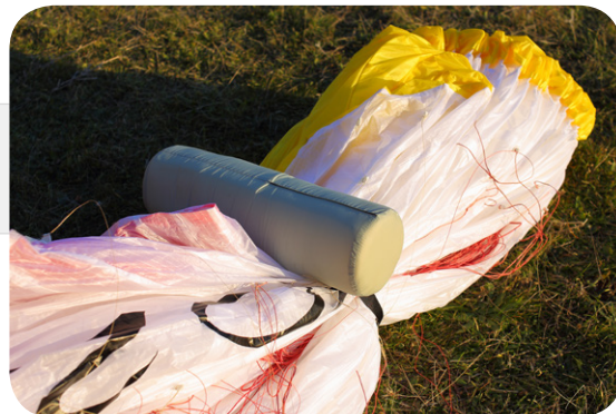
図5. 一折り目となりそうなあたりにフォールディング枕をおいて、リーディングエッジ側を折りたたみます。枕はたたむ角度を緩やかにしプラスチックワイヤーが曲がらない様に保護してくれます。次にトレーリングエッジ側をたたんだリーディングエッジの上に緩やかな角度で折り重ねます。
