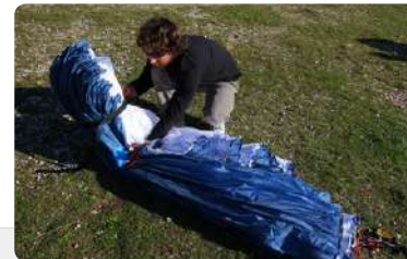
図6. プラスティックロッドを折り曲げないようにグライダーを三つ折りあるいは四つ折りとします。
