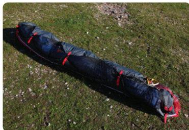
図9. ウィンナーバッグを横向きにし、リーディングエッジの補強プラスチックのすぐ後ろでプラスチックを折り曲げないように注意しながら一折し、その後三つ折りあるいは四つ折りにします。
