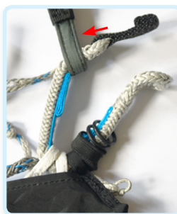
ライザーにリンクライトを差し込む
